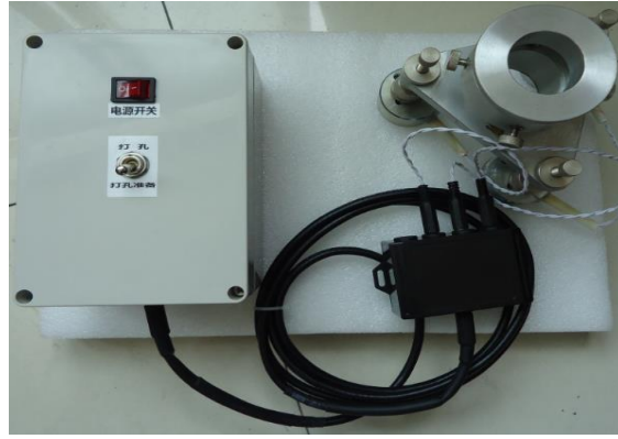
电磁吸盘与电源盒、适配器连接示意图
