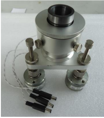
安装电磁吸盘的钻孔平台
